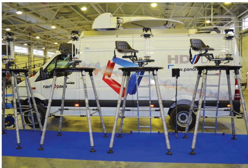
Передвижная станция спутниковой связи и операторские платформы
